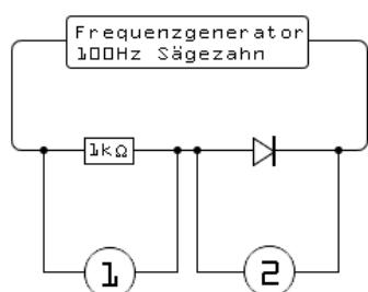
Die Kontakte in der Mitte zwischen Widerstand und Diode wurden an die Masse des Oszilloskops, die äusseren an die entsprechenden Eingänge angeschlossen.
